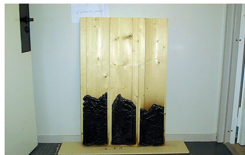
Brandprovning av golvbeläggningar enligt Radiant panel, SS-EN ISO 9239-1.
