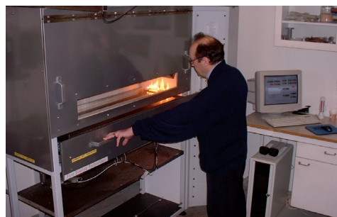
Brandprovning av golvbeläggningar enligt Radiant panel, SS-EN ISO 9239-1.
