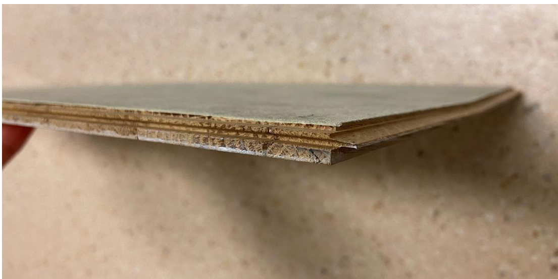
Bild 3 – Närbild av tvärsnitt. Golvet har not och fjäder vid dess gränssytor. Golvskivorna är ihopslagna vid provningen, ej limmade.
