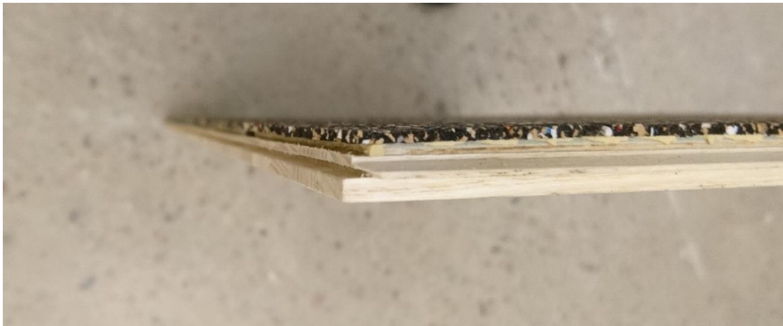
Bild 3 – Närbild av tvärsnitt. Golvet har not och fjäder vid dess gränssytor. Golvskenorna är ihopslagna vid provningen, ej limmade.
