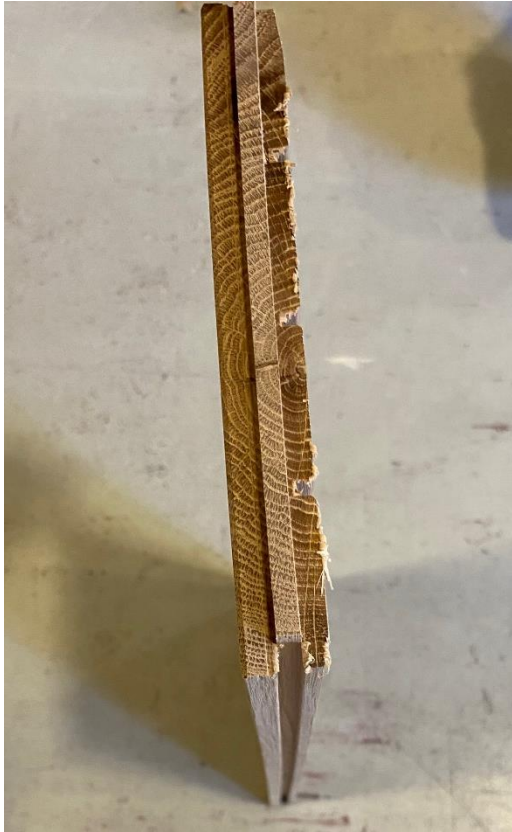
Bild 3 – Närbild av tvärsnitt. Golvet har not och fjäder vid dess gränsytor. Golvskivorna är ihopslagna vid provningen, ej limmade.
