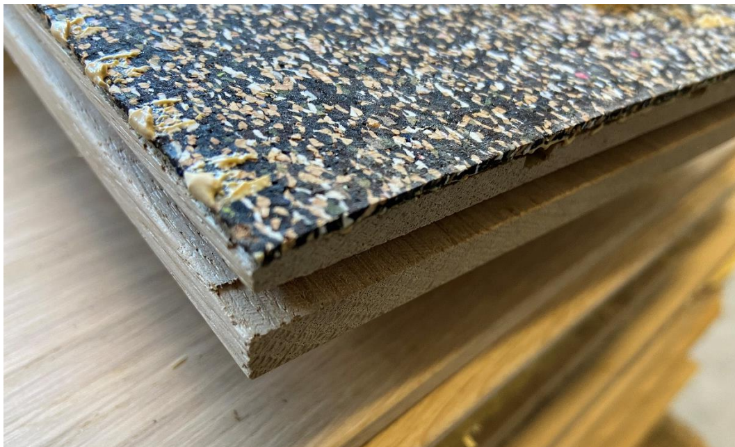
Bild 2 – Undersidan av golvbrädorna med den pålimmade korkmattan.
